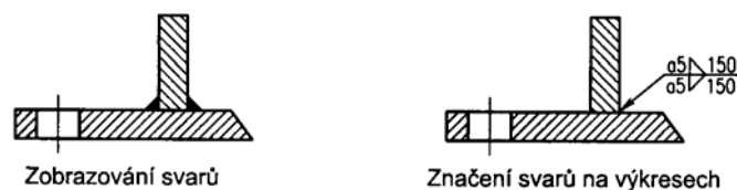
Obrázek č. 8.84. Rozdíl mezi zobrazením a označením svaru
