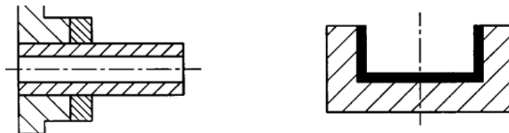
Obrázek č. 3.44, Šrafování stýkajících se součástí
